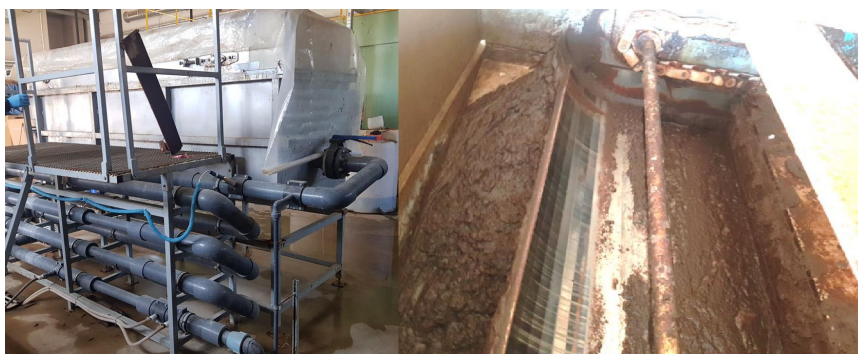
Фото 9. Флотатор, флотационная камера
