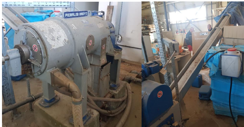
Фото 13. Декантерная центрифуга, шнековый транспортер
